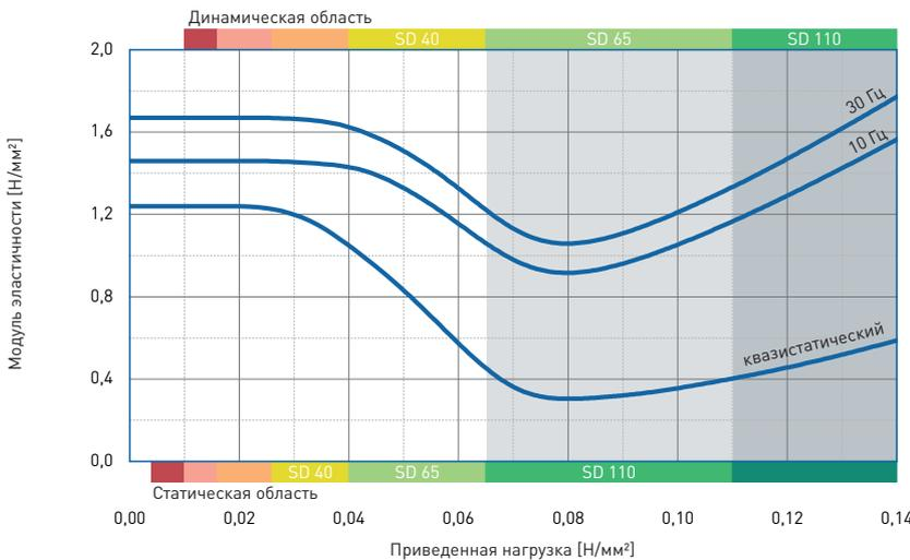
Динамический тест: синусоидальное возбуждение с амплитудой  $\pm 0.22$  мм при 10 Гц и  $\pm 0.08$  мм при 30 Гц
