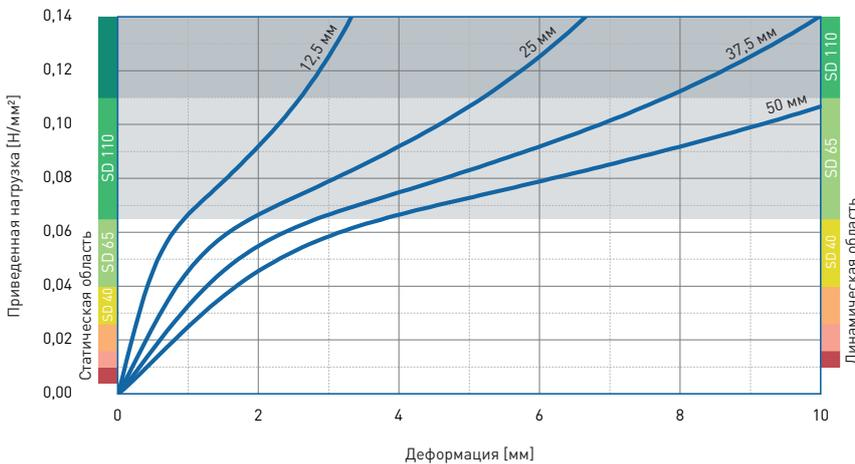
Запись 3-го цикла нагружения; образец помещен между стальными пластинами; измерения при комнатной температуре и скорости нагружения 1% от толщины образца в секунду
