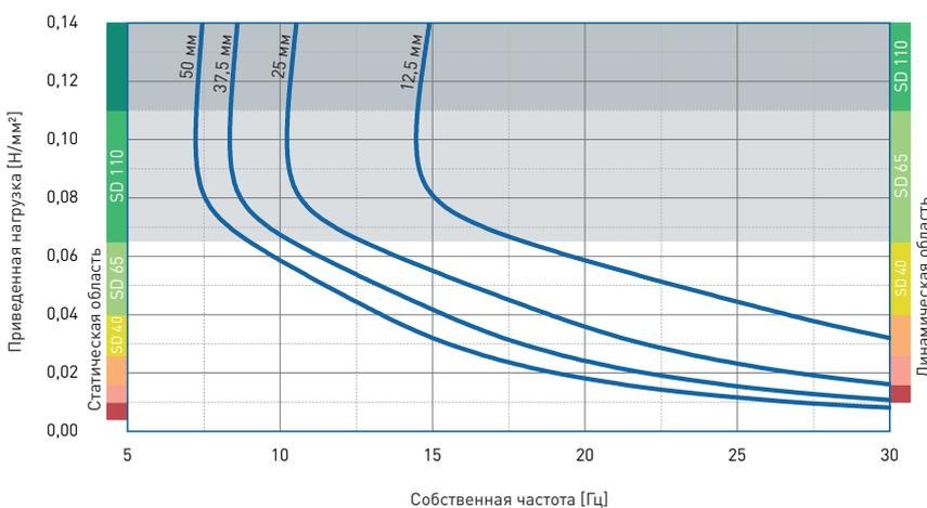
Собственная частота системы с одной степенью свободы, состоящей из постоянной массы и эластичного слоя PURASYS **vibrafoam** SD 65 на жесткой подоснове.
